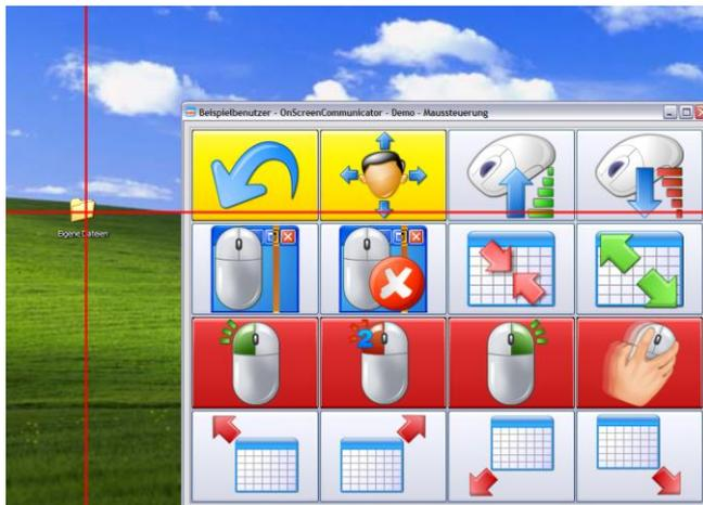
Während sich die Linien über den Bildschirm bewegen wird die Mausseite transparent. Auf diese Weise können auch Dateien geöffnet werden, die sich unter der Oberfläche des OnScreenCommunicators befinden.
