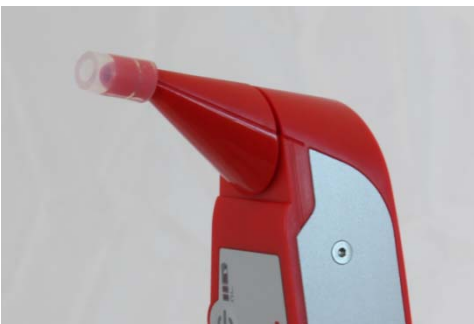
Abbildung 8: Korrekter Sitz des Silikonschlauchstücks.
